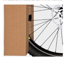
Die Stabilisierungseinlage sorgt für einen festen Stand des Fahrrads im Fahrradkarton.
